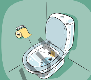
Kuva 2. Jos WC-paperi kastuu pöntön reunalla, WC-istuimen vesisäiliö vuotaa.
